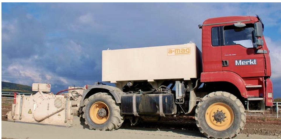
Der a-mag-Multifunktionstrac MFT MX auf der Baustelle: Die großvolumigen Anbauräume machen das universelle Zugfahrzeug zu einem idealen Geräteträger. Das Bild zeigt das Hightech-Zugferd mit einem 9000 l-Tank.
